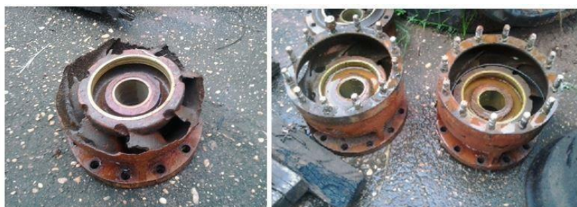
Figura 3.1 - Corrosão nos equipamentos
